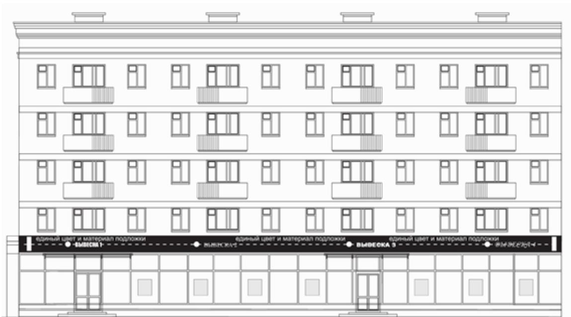
Рисунок 6. Рекомендуемый пример размещения вывесок (информационных конструкций) на общем фризе здания
