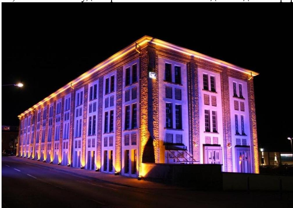
3) контурное освещение. Организация освещения по контуру стен – оригинальный прием, который начали применять недавно. Сейчас контурная подсветка
