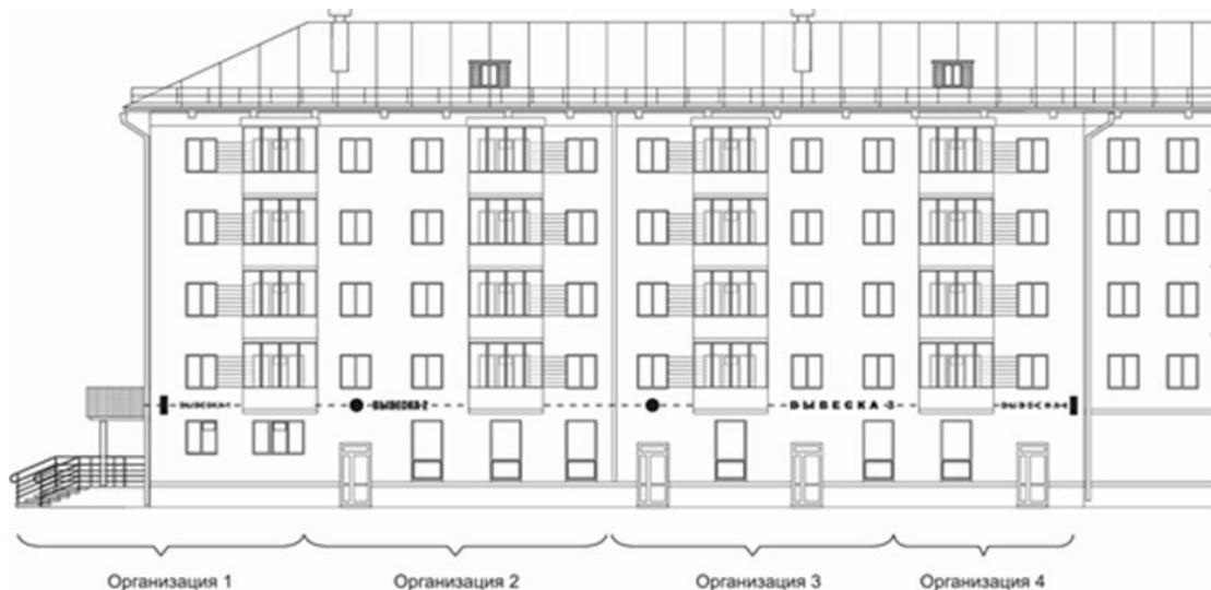
Рисунок 1. Допустимое размещение вывесок (информационных конструкций)
