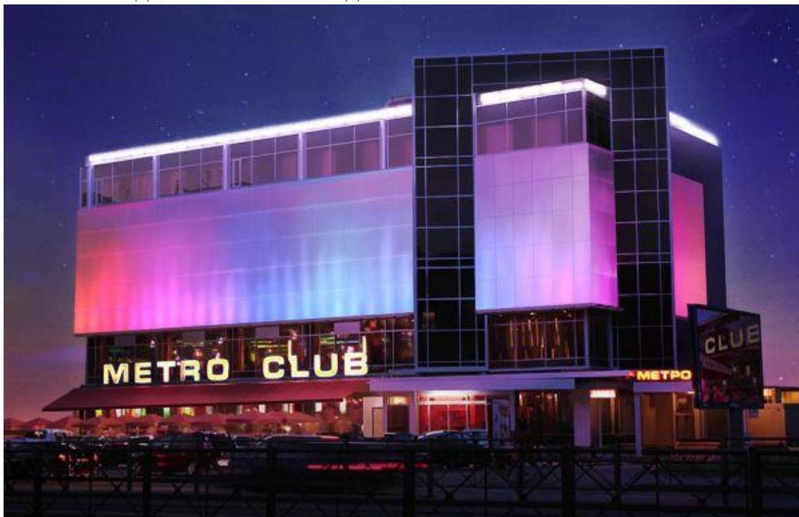
б) динамическое освещение. Для такого типа освещения монтируют цветодинамические системы, в результате фасад будет подсвечен разными цветами. Через определенное время они меняются, как и яркость подсветки. Для монтажа используют прожекторы, диоды, ленты, точечные источники света
