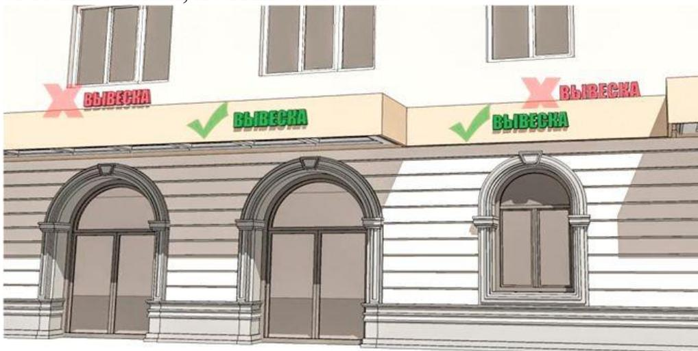
Размещение панелей-кронштейнов. Высота панелей-кронштейнов и места их размещения привязывается к вывескам других видов на фасаде или к архитектурным деталям, членениям фасада.
